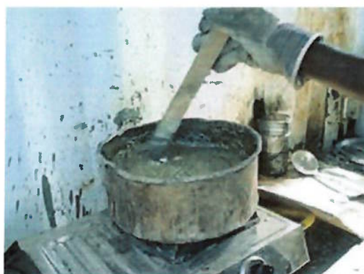
Figura 16 – Leva-se a panela com a mistura ao fogo por aproximadamente 15 minutos
