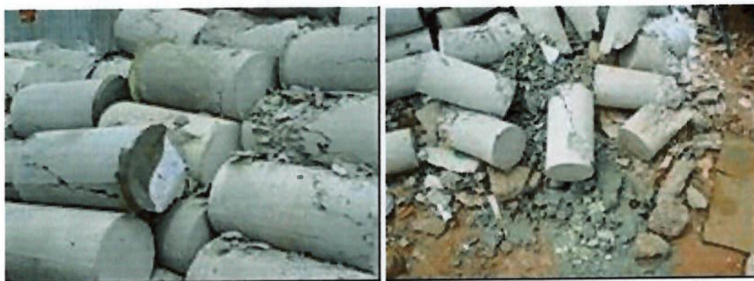
Figuras 21 e 22 – Deposição indevida dos corpos de prova com enxofre
