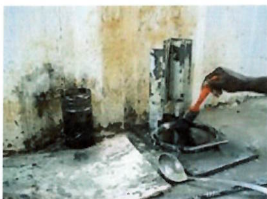
Figura 17 – A fôrma onde será feito o capeamento é besuntada de óleo
