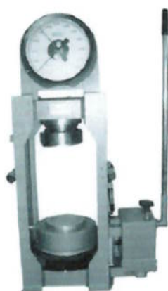
Figura 8 – Prensa hidráulica manual com manômetro
