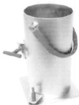
Figura 10 – Fôrma cilíndrica para moldagem de corpos de prova
