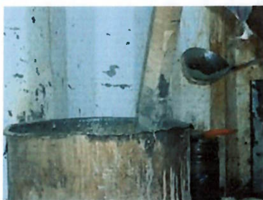
Figura 18 – Utiliza-se uma concha para transferir a mistura de enxofre e cimento aquecida para moldar o corpo de prova no capeamento
