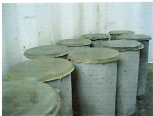
Figura 20 – Após o arrefecimento da mistura está pronto o capeamento dos corpos de prova para serem encaminhados à prensa para determinação da resistência
