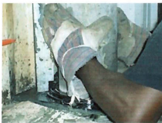
Figura 19 – Coloca-se o corpo de prova na fôrma com a mistura do capeamento
